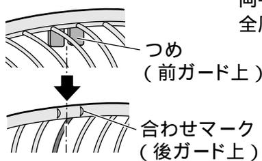
ガード止めねじをゆるめ、ガードリングからクリップをはずす。両手で前後ガードの全周をはめ込み、
