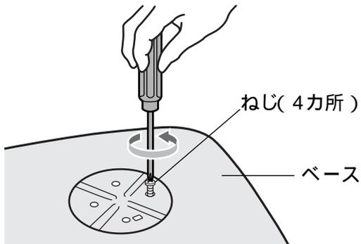
支柱のつめをベースの穴に差し込んで、ねじ(4カ所)を締め付けて、キャップを下ろす。
