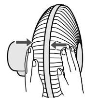
ガード止めねじを溝に差し込み、締め付ける。
