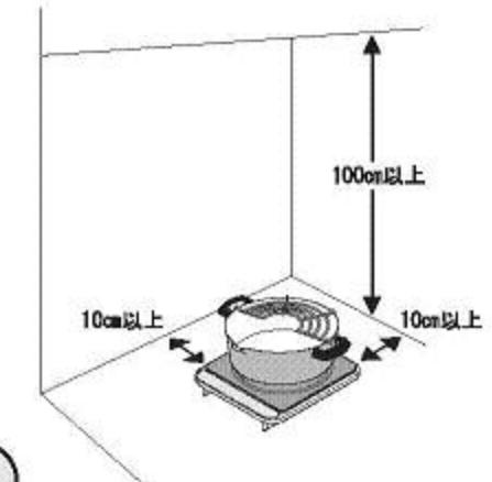
製品を10cm以上壁より離さないと十分な内部冷却が出来ず安全装置が働く場合がありますのでご注意下さい。
