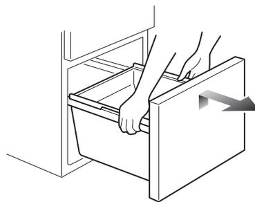
トレイを外してから、左右のレールを持って、手前を持ち上げながらドアごと外します。
