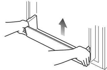
取り外しがかたいときは、左右の端を軽く突き上げながら外してください。
