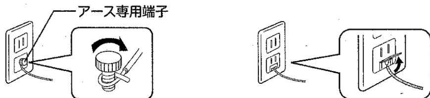
アース線先端の被覆を取り去って、アース端子に確実に固定してください。
