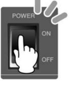
スピーカーから大きなノイズが発生しないようにするため、音源に近い機器から順に電源を入れてください。
