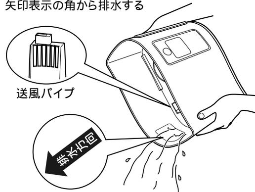
エアフィルター・送風パイプの穴に、水が入らないように排水してください。水が入ると、故障の原因になります。多少水アカが残っていても使用できますので、蒸発皿を金属タワシ等でこすらないでください。蒸発皿の塗膜層に傷がつくと、蒸発皿が腐食する原因になります。
