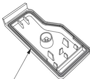
4. ろ過部(ウレタン)は洗い油または中性洗剤を水で薄めて洗い、よく絞って乾かします。オイルに浸した後、固く絞ってから取付けます。
