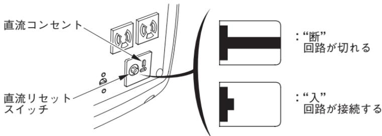
直流コンセントは直流電気を取出すところで、12Vバッテリーの充電専用です。交流電気を使用しているても直流電気を取出すことができます。充電コード(別売部品)のプラス、マイナスは極性に注意し、接触不良のないように確実に接続してください。充電コードの接続のしかたは36頁を参照してください。
