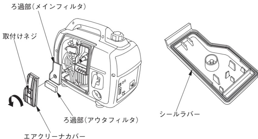
4. エアリーナカバーに取付けられたシールラバーに損傷がないこと、また確実に取付けられていることを確認します。
