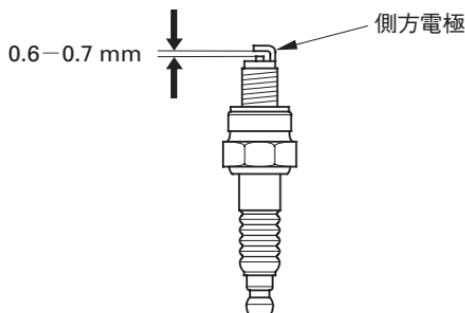
6. 取付けはまず手で一杯までねじ込み、次にプラグレンチで確実に締付けます。
