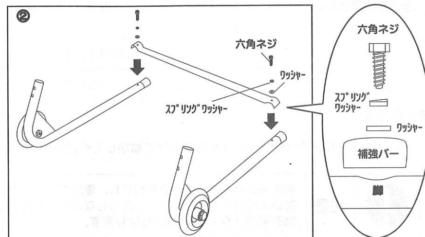
③脚にメインフレームを差し込み、六角ネジセットで本体に取り付けます。
