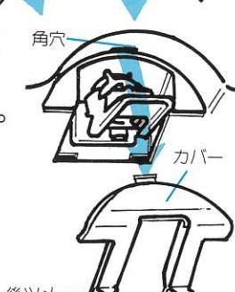
2 連続注水の要領⑪でレバー先端を手前に引きながら、強く持ち上げるとレバーがはずれます。
