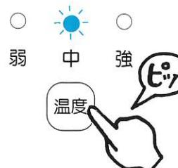
温度を調節したあと「冷」または「温」の冷温水スイッチを切り換えると「強」にもどります。
