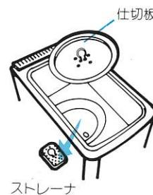
3 タンク内と仕切板とストレーナを食器用洗剤とスポンジなどで清掃し、きれいな水で洗い流します。
