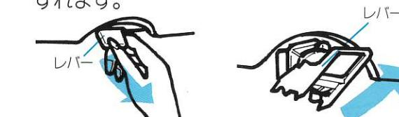
3 注水弁を左の方向（反時計方向）に回し注水弁を取り出します。
