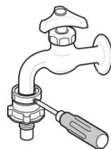
4 ラベルをはがして締付ボディを矢印方向へ回して、締めしろが1~2mmになるまで十分締め付ける
