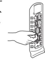
3 糸くずフィルターを元どおり取り付ける糸くずフィルターの穴に本体フィルター取付部の凸部を差し込んでから全体を押し込む
