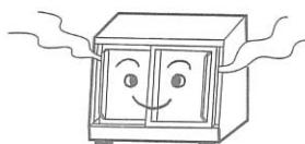
これは加湿バットからの水蒸気ではなく食材から発生する蒸気によるものです。この様な場合には引き違いガラス戸を少し開いて(15~20mm程度両側)庫内より蒸気をにぎして使用されるようお願いします。(蒸気の発生が収まりましたら引き違い戸を閉めて保温してください。) そのまま使用されますと本器ケースの外に水滴が流れ出したり、漏電や感電等のトラブルの原因となりますので充分ご注意ください。
