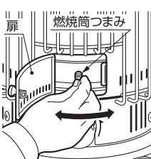
燃焼筒が正しくセットされていないと、異常燃焼し、多量のすすが発生したり、火災になるおそれがあります。
