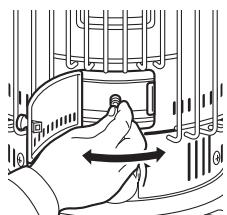
燃焼筒が正しくセットされていないと、異常燃焼し、多量のすすが発生したり、火災になるおそれがあります。
