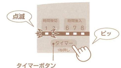
時間設定してから8秒後にタイマーランプが点滅から点灯に変わり、タイマーがセットされます。
