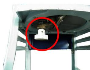
氷の荒さはレバーで調整可能です。出庫時は刃をねかせた状態に設定されています。お好みの角度に調整して下さい。
