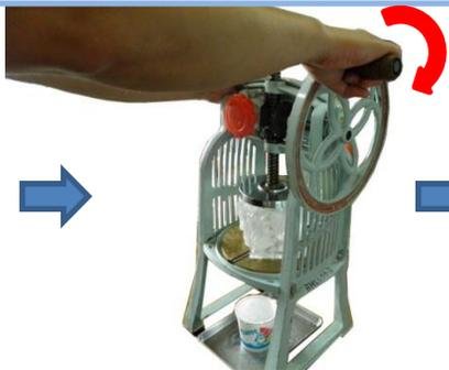
付属のトレーをセットしカップを置きます。右手でハンドルを回します。左手で本体を抑えると使いやすいです。
