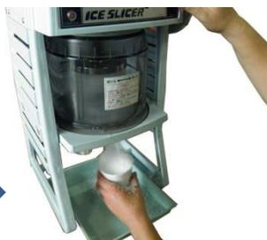
カバーつきの場合、氷削る時は右方向に回しストッカーにあたるまで確実に閉じて下さい。閉じ方が不十分の場合スイッチが入りません。※スライドカバーの開閉を電源スイッチの変わりにはしないで下さい。
